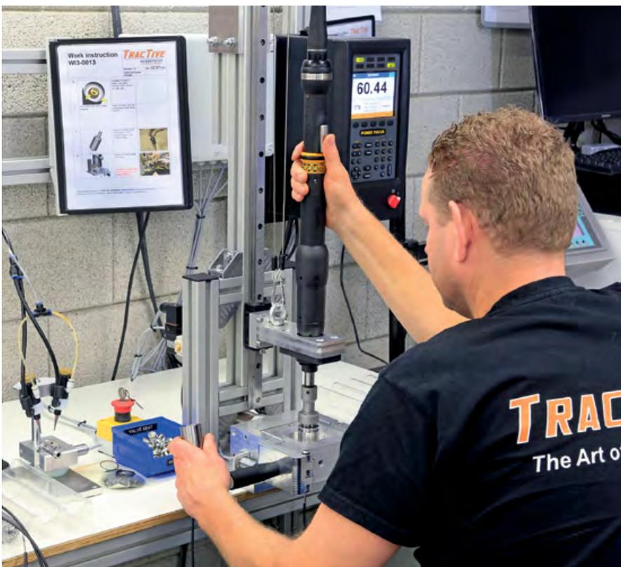
Fehlende Komponenten, falsche Drehmomente und selbst fehlenden Dichtklebstoff erkennt das Tensor-Schraubsystem während der Produktion. Werker und Anlage werden gewarnt, das fehlerhafte Bauteil wird blockiert. Die intelligent vernetzte Montage dokumentiert alle wichtigen Fertigungsschritte, erhöht die Qualität und sichert Prozesse zuverlässig ab.
