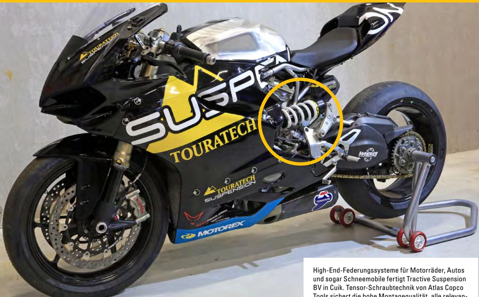
High-End-Federungssysteme für Motorräder, Autos und sogar Schneemobile fertigt Tractive Suspension BV in Cuik. Tensor-Schraubtechnik von Atlas Copco Tools sichert die hohe Montagequalität, alle relevanten Anziehdaten werden dokumentiert.
