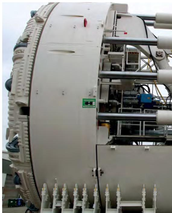
Der Vortrieb dieser Tunnelbohrmaschine hat einen Durchmesser von rund 10 m. Pro Minute werden etwa 100 mm Tunnel aufgeföhren.
