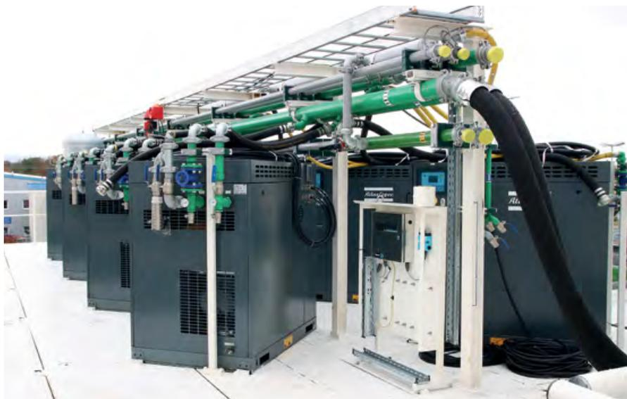
Herrenknecht stattet seine Tunnelbohrmaschinen mit modifizierten GA-Kompressoren von Atlas Copco aus; meistens mit 45 bis 90 kW installierter Motorleistung. Die Station auf dieser TBM besteht aus vier GA 90 HE (linke Flanke) und fünf GA 55 HE (rechte Seite).
