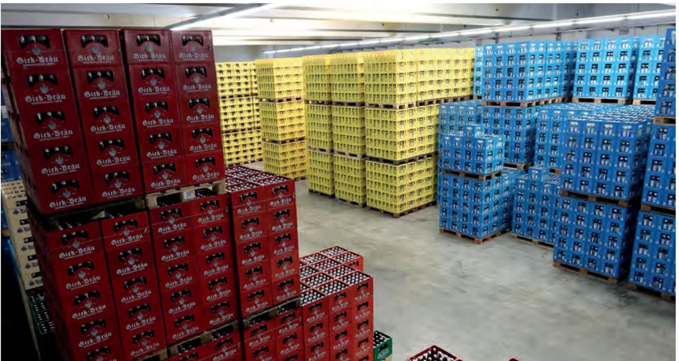
In der Lagerhalle trocknen die Etiketten auf den Flaschen gut ab; denn die Hallenluft wird von der warmen Kompressoren-Abluft erwärmt und über Ventilatoren an der Decke in Zirkulation gebracht.
