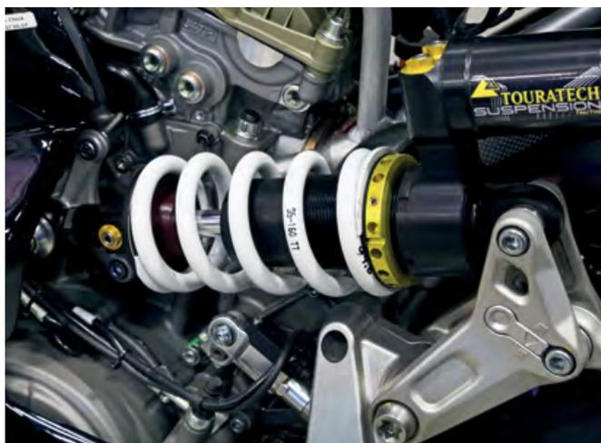
Auf dem Weg zur Komplettierung werden Federungssysteme bei Tractive Suspension mehrmals geprüft. Etwaige Verschraubungsfehler deckt das in die Fertigungslinie eingebundene Tensor-Schraubsystem auf. Alle relevanten Fertigungsschritte werden dokumentiert.
